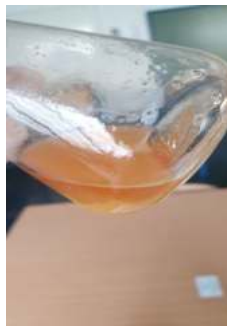
Imagen 6.- Color que toma la disolución de fenolftaleína + aceite al ser sometido a la volumetría
